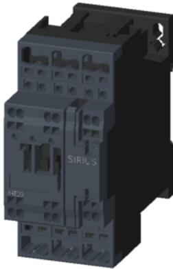
Leistungsschütz, AC-3 17 A, 7,5 kW / 400 V 1 S + 1 Ö, AC 208 V, 50/60 Hz
