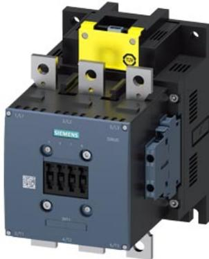
Schütz, AC-1, 500 A/690 V/40 °C, S10, 3-polig, AC/DC 200-277V, F-PLC-IN, mit Varistor, 2S+2Ö, Anschlussschiene/ Schraubanschluss
