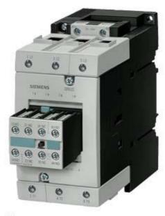
Leistungsschütz, AC-3 95 A, 45 kW / 400 V DC 24 V, 3-polig, Baugröße S3 Federzuganschluss 2 S +2 Ö, unlösbar !!! Auslaufprodukt !!! Nachfolger ist SIRIUS 3RT2 Präferierte Nachfolgertype ist >>3RT2046-3KB44-3MA0<<
