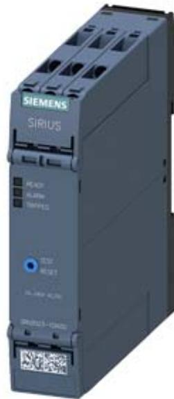
Thermistor-Motorschutzrelais Gerät für Warnen und Abschalten 22,5 mm Gehäuse Schraubanschluss 1 Schliesser + 1 Wechsler US = AC/DC 24 V-240 V Hand/Auto/Fern-RESET mit ATEX-Zulassung 3 LEDs (READY/WARNING/TRIPPED) sichere galvanische Trennung Test-/RESET-Taste Drahtbruchüberwachung Kurzschlussüberwachung nullspannungssicher 2 getrennte PTC-Fühlerkreise
