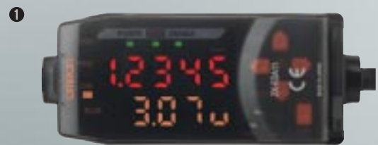
El doble display digital de fácil lectura muestra los resultados de las medidas o la configuración de las diversas funciones.
