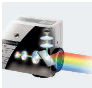
Tres fuentes de luz (R, G, B) en un solo dispositivo
