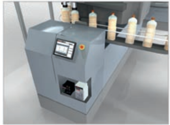
O controlador de segurança programável com I/O de segurança local controla a aplicação de segurança completa.
