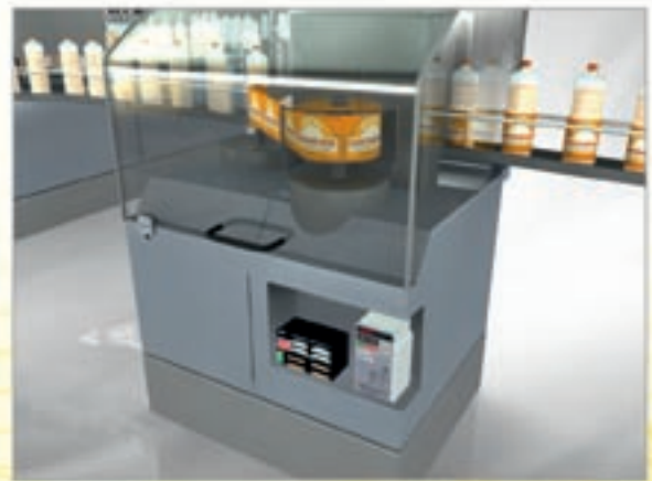
A desactivação segura é controlada por um módulo I/O de segurança, que monitoriza adicionalmente os interruptores de porta de segurança.
