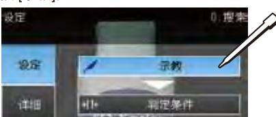
将用作测量参考的对象置于照相机前。移动矩形框，使位置补偿的特征部分位于矩形框内。
