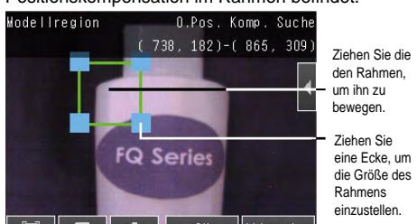
Kontrollieren Sie den Bereich, drücken Sie die [OK]-Taste und drücken Sie die [TEACHEN]-Taste. Damit werden der charakteristische Teil und die Referenzposition des Gegenstands für die Positionscompensation registriert.
