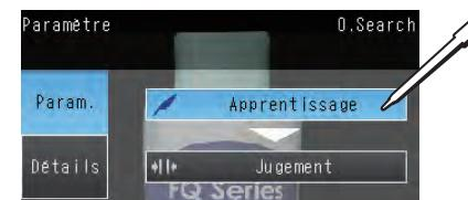
Placez l'objet qui doit être utilisé comme référence de mesure en face de la caméra. Déplacez le rectangle de sorte que la partie caractéristique pour la compensation de position y soit à l'intérieur.
