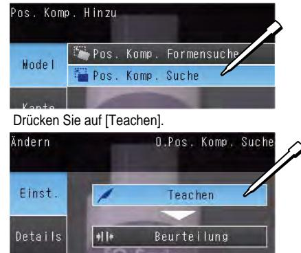
Bringen Sie das gewünschte Messreferenzobjekt vor die Kamera. Bewegen Sie den Rahmen, so dass sich der charakteristische Bildteil für die Positionscompensation im Rahmen befindet.
