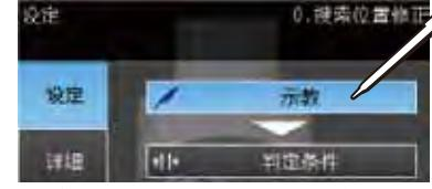
将对象置于照相机前，用作测量参考。移动矩形框，使要“位置补偿”的商标特征位于框内。
