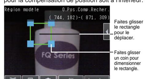
Vérifiez la zone, appuyez sur le bouton [OK], puis appuyez sur le bouton [Teach]. La partie caractéristique et la position de référence de la compensation de position sera enregistrée. Appuyez sur [Précédent]. Vous pouvez ajouter des éléments de filtre pour régler l'image afin de simplifier la mesure. Reportez-vous au manuel de l'utilisateur pour plus d'informations.
