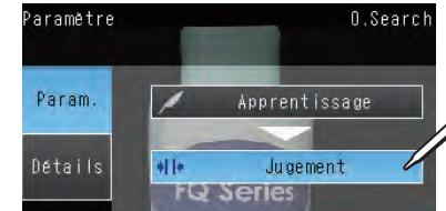
Réglez les paramètres de jugement tandis que vous entrez des modèles d'images. Appuyez sur le paramètre de condition de jugement pour régler les limites supérieure et inférieure d'un jugement OK.
