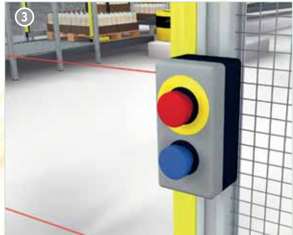
Pulsador de reinicialización de confirmación y arranque
