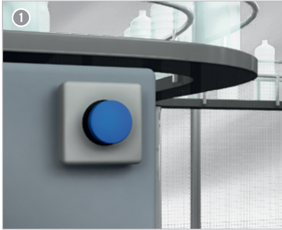
Pulsador de reset previo dentro de la máquina que se debe activar para que el sistema de seguridad se pueda reinicializar
