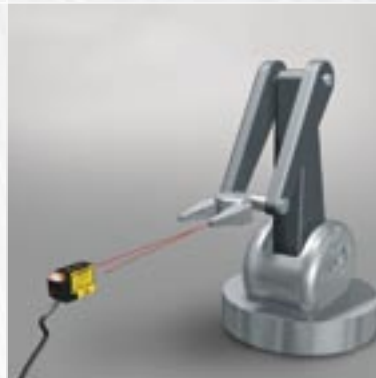
Orientação de posicionamento de braço mecânico para calibração
