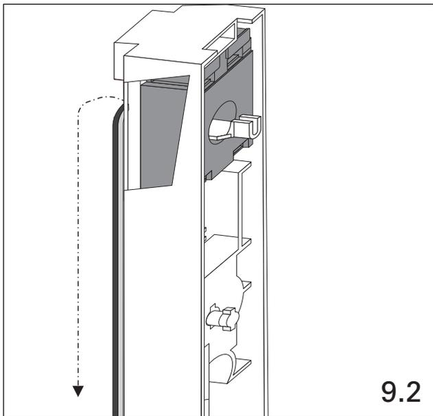
11. Meldeschalter-Einbau Pilot switch-assembly
