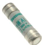
**Cartuccia fusibile, Bassa tensione, 8 A, AC 500 V, 10 x 38 mm, aM, IEC, con indicatore**
