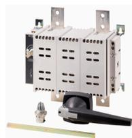
**Interrupteur-sectionneur courant continu, 2 pôles, 1250 A, avec poignée rotative grise, Encastrement / Montage encastré avec fixation arrière, avec axe métallique de 300 mm**
