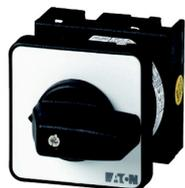
**Polumschalter, Kontakte: 7, 20 A, 2 Drehzahlen, 2 getrennte Wicklungen, Frontschild: 0-1-2, 60 °, rastend, Einbau**
