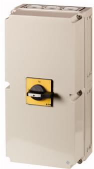
**Interrupteur général, 6 pôle + 1 Contact F + 1 Contact O, 315 A, Fonction d'arrêt, 90 °, verrouillable en position 0, Montage en saillie**
