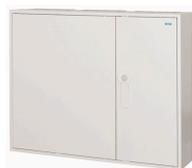
**Wandgehäuse EWS für Normeinbaueinheiten EP, IP43, IK09, Schutzklasse 2, RAL9016 , ohne EP Module, HxBxT=650x800x210mm**
