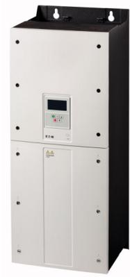
**Frequenzumrichter, 3-/3-phasig 230 V, 150 A, 37 kW, Vektorsteuerung, EMV-Filter und Bremstransistor integriert**
