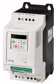
**Frequenzumrichter, 1-/3-phasig 230 V, 4,3 A, 0,75 kW, Vektorsteuerung, EMV-Filter und Bremstransistor integriert**
