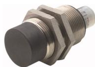
Näherungsschalter, induktiv, 1S, S<sub>n</sub>=15mm, 3L, 6-48VDC, NPN, M30, Metall, M12
