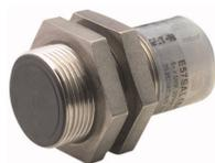
Näherungsschalter, induktiv, 1S, S<sub>n</sub>=5mm, 3L, 6-48VDC, NPN, M18, Metall, M12
