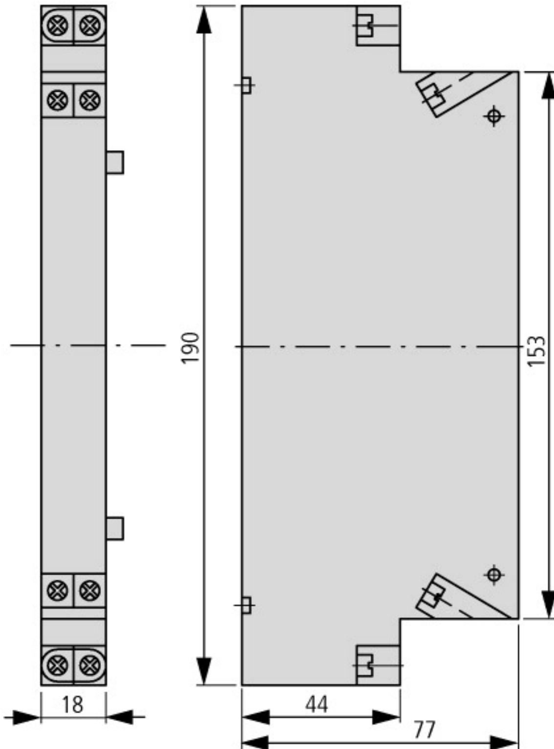
Contacts auxiliaires de position pour ensembles disjoncteur + contacteur(-limiteur)
