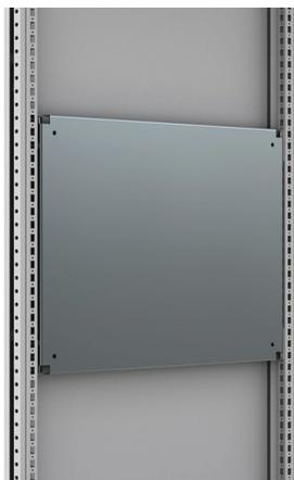
: Устанавливаются непосредственно на шкафную раму или на самозащелкивающиеся профили (CLPK). Особая конструкция позволяет выполнять установку всего одному человеку. Может быть установлена на любой высоте или глубине в соответствии с расположением 25 мм отверстий. При соответствии размера, она может быть установлена на боковой стороне шкафа.
