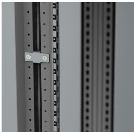
: Маленькие крепежные скобы, монтируемые на отверстия с внешней стороны стыкованных шкафов, обеспечивающие необходимый зазор между шкафами. Скобы специально сконструированы для конструкций с маленькими дверями/панелями. Дополнительным преимуществом такого соединения является прямое заземление шкафов между собой.
