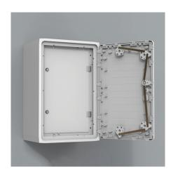
**Descrição:** Para controlodores, equipamento de medição, sinalizadores,etc. As dobradiças podem ser montadas de forma a abrir à direita ou à esquerda. Fechadura DIN de 3 mm. Distância entre o UID e a porta do armário: 48 mm.
