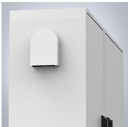
**Descrição:** É necessários instalar dois respiradores por armário para garantir a circulação de ar e impedir a condensação de água. Os respiradores devem ser montados preferencialmente na parte superior e inferior do armário. Grau de protecção: IP 44.
