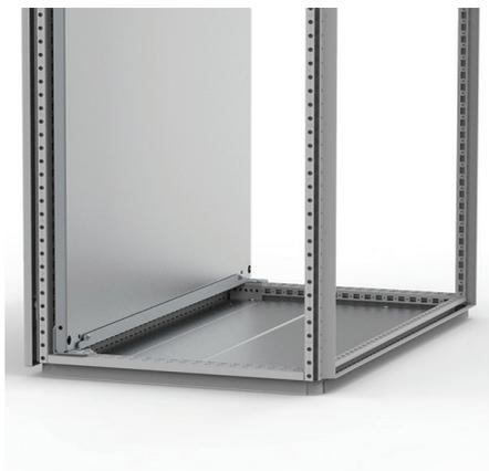
**Descrição:** Cria uma superfície de instalação em toda a largura do armário. Fácil instalação se usar os perfis deslizantes MTS desde a lateral. Largura útil igual á largura do armário. Quando se unem armários os MPW podem ser unidos e ser utilizados como uma superfície de instalação única. Não pode ser montada na posição profundidade máxima do armário.
