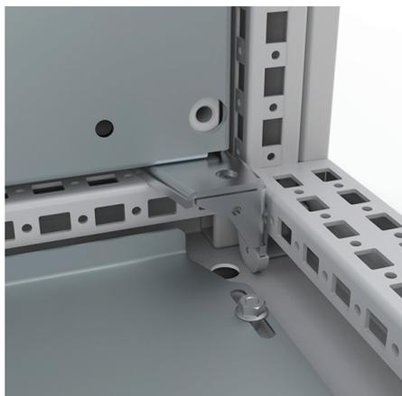
**Descrição:** Para fixar platinas de montagem na parte posterior do armário, incluir suportes ajustáveis para regular a profundidade em passos de 25 mm. São necessários suportes quando se necessita de uma platina adicional ou quando se pede um armário sem platina (PE).
