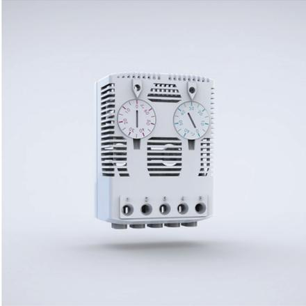
**Descrição:** Higróstato-termostato eletrônico monitora a umidade relativa e a temperatura independentemente um do outro, e ele gerencia resistência e ventiladores para evitar a condensação e a corrosão no interior do armário. Montagem do grampo para 35 mm DIN (EN 60715).
