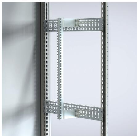
**Descrição:** Perfis de montagem de altura parcial para obter um sistema de montagem em 482.6 mm (19") em todos os lados. Totalmente ajustável em profundidade em passos de 25 mm. Para usar-se em combinação com perfis CLPK.
