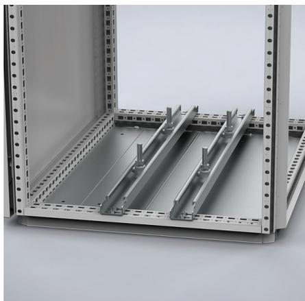
**Descrição:** Barra de alto esforço para a montagem de equipamentos pesados, tais como: transformadores. Fornecido com parafusos deslizantes em T e equipado com furos rasgados para a montagem em qualquer posição, tanto em largura com em profundidade do armário.
