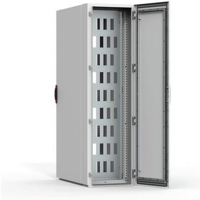
**Description:** Plaque d'interconnexion à placer entre deux armoires ou à combiner avec une porte latérale rehaussée (DNSR). Perforations pour connecteurs 24 broches. Les plaques d'obturation MMG permettent de l'adapter aux connecteurs 16 broches. À monter avec un kit de support CCJ 12.
