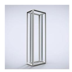
**Description:** Profilés verticaux avec perforations 25 mm pour soutenir des rails DIN et des plaques de fixation Telequick. Profondeur réglable par pas de 25 mm.
