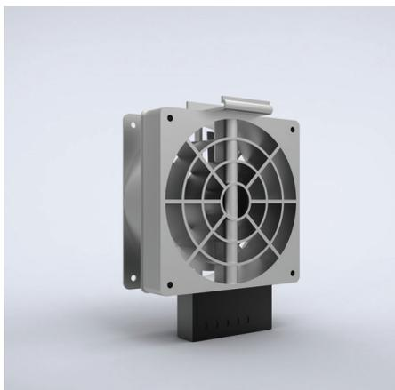
**Description:** Résistance chauffante ventilée hautes performances et compacte pour éviter la condensation. Le ventilateur aide à une meilleure convection naturelle pour mieux répartir la chaleur dans les grandes armoires. Clip de fixation pour rail DIN 35 mm (EN 60715). Dispositif de coupure de sécurité pour éviter la surchauffe en cas de panne du ventilateur. Réinitialisation automatique.
