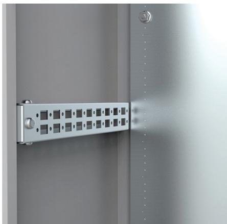
**Description:** La gamme DIP comprend des profils de 40 mm de large et 25 mm de haut, prévus pour être montés dans la profondeur de l'armoire. Ils peuvent aussi être combinés avec des profilés CLPF ou CLPK. Présentent 2 rangées de perforations pour écrous-cages et vis auto taraudeuses. Les profils DIP ne sont pas compatibles avec le réglage en profondeur de la plaque de montage.
