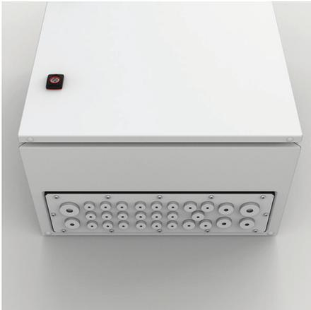
**Description:** Le passe-câbles en caoutchouc est très simple à utiliser. La pose est plus économique puisqu'elle ne requiert aucun outil. La membrane push-out est un joint permanent jusqu'à la pose d'un câble ou d'un tuyau. Convient à une pose sur des parois de 0,5 à 4 mm d'épaisseur.
