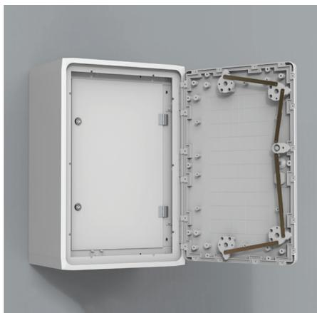
**Descripción:** Para controles, aparatos de medida, lámparas, etc. Las bisagras pueden montarse para permitir la apertura a derecha o a izquierda. Cierre DIN de 3mm. Distancia entre UID y la puerta del armario : 48 mm.
