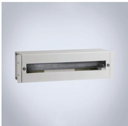
**Descripción:** Para instalación de interruptores de circuito, interruptores o enchufes en racks. Aperturas para un máximo de 22 módulos (18 mm). Carril DIN ajustable en profundidad por 15 mm. El cuerpo está equipada con 2 carriles de toma a tierra 10x8 mm. La longitud es de 120 mm con 15x M5 conexiones cada una. La entrada de cables está en la parte posterior de 400x35 con apertura de escobilla.
