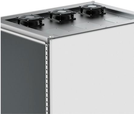
**Descripción:** Dos versiones de ventiladores: DFN01 para montarse en una superficie desde abajo, DFN02 para montarse encima de la superficie, entre tanto el aire circula hacia arriba. El kit de cableado consiste en un bloque de conectores para un máximo de 6 ventiladores. Contacto extra provisto para conexión del termostato.
