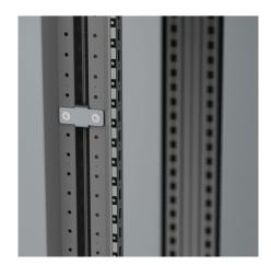
**Descripción:** Soportes reducidos para fijarlos en los taladros exteriores de la estructura de los armarios combinados con función de "auto-espaciado". Especialmente diseñado para configuración con pequeñas puertas o paneles. Este método de unión de armarios de acero dulce tiene la ventaja de conexión directa de tierra entre las estructuras de los armarios.
