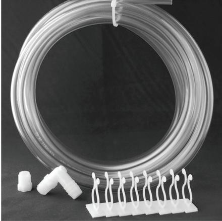
**Descripción:** Tubo flexible de vinilo utilizado para dirigir directamente el aire frío para su circulación o a puntos calientes. Incluye conector del tubo, tapón de cierre y material de fijación del tubo. Si se utiliza el tapón de cierre se deben hacer taladros de al menos 6,32 mm de diámetro para evitar contrapresión excesiva en el refrigerador. Los taladros se pueden perforar o cortar en el tubo (en forma de "v").
