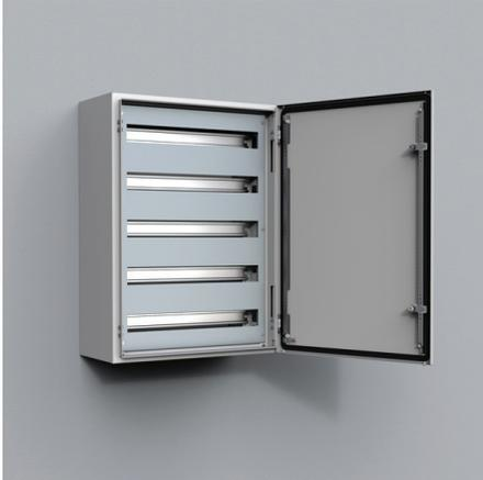
**Descripción:** Utilizado para facilitar el montaje de los elementos de carril DIN con una altura máxima de 68 mm. Distancia entre filas: 125 mm. En caso necesario, la puerta del armario estándar puede ser sustituida por una puerta transparente. La distancia útil entre el chasis y la puerta es de 35 mm. En armarios de acero inoxidable se requiere mecanizado.
