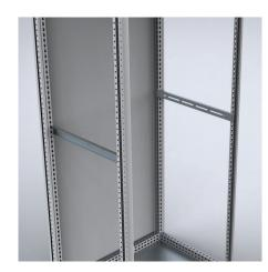
**Beschreibung:** Profile, Teleskop-Geräteböden SHT in voller oder Teiltiefe zu montieren. Erlaubt z.B. den Einbau eines 600 mm Bodens in einen 800 mm tiefen Schrank. Sie werden direkt an die Schrankprofile montiert. Auf ganzer Höhe in 12,5 mm Schritten verstellbar.
