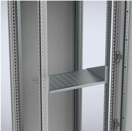
**Beschreibung:** Zur Befestigung an den Frontprofilen. Der Geräteträger kann nach vorne oder nach hinten hin ausgerichtet werden. Bei zusätzlicher Befestigung hinten kann er 100 kg tragen.
