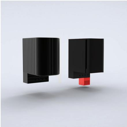
**Beschreibung:** Doppelt isolierte, vertikale Heizung zur Vermeidung von Kondensat. Mit Clip zur Befestigung an 35mm DIN-Schiene gemäß EN 50022. Berührungssicher da Temperatur des Heizungs-Gehäuses niedrig gehalten wird. Die Heizung mit Thermostat (ECHT) wird mit einem Einsteck-Thermostat geliefert, so dass keine zusätzliche Verdrahtung notwendig ist. Schaltet an bei 5 °C und aus bei 15 °C.
