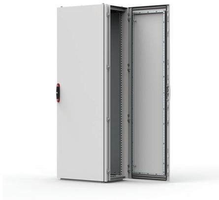
**Beschreibung:** Anstelle der Seitenwand SPM, zum einfachen Zugriff auf Einbauten von der Seite aus oder wenn Schaltschränke Rückseite an Rückseite montiert sind. Ausgestattet mit einem 3 mm DIN Doppelbart Schloss, dass alle Verriegelungsoptionen ermöglicht. Türmontagerahmen sind optional.
