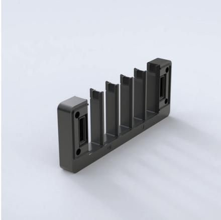
**Beschreibung:** Plastik Kabeleinführung zur schnellen, wirtschaftlichen und werkzeugfreien Einführung von Steckern. Mit integrierter Dichtung. Die Klick-Montage ist passend für Wandstärken von 1,4 - 2 mm, Installationshöhe 14mm. Es hat zehn Öffnungen die mit zehn CCG Kabeldurchführungstüllen abgedeckt werden.
