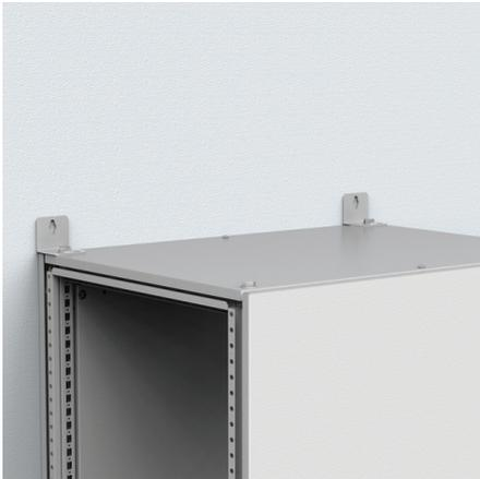
**Beschreibung:** Befestigung des Gehäuses an der Wand, mithilfe von M12-Schrauben oben am Gehäuse. Verhindert das Umkippen des Gehäuses, z. an Bord von Schiffen. Kompatibel mit anreihbaren und kompakten Standschränken.
