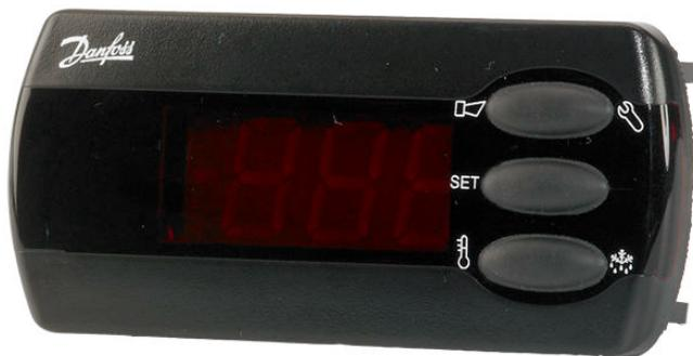
L'EKA 153 è un termometro usato per registrare fino a tre temperature in combinazione con i controlli dell'apparecchio di refrigerazione. Le temperature possono essere lette dal display e inviate a un'unità di sistema centrale tramite la trasmissione dati.
