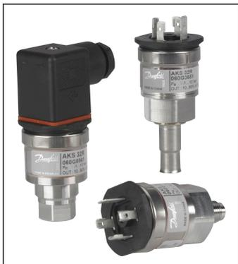
L'AKS 32R è un trasmettitore di pressione raziometrico che converte la pressione misurata in un segnale lineare in uscita. Il segnale di uscita è relativo alla tensione di alimentazione, il che significa che l'uscita di pressione minima sarà il 10% della tensione di alimentazione effettiva e l'uscita di pressione massima sarà il 90% della tensione di alimentazione effettiva.
