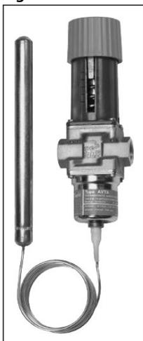
Le valvole termostatiche AVTA per acqua sono ampiamente utilizzate per la regolazione della temperatura in molte macchine e impianti in cui è richiesto il raffreddamento. Le valvole dell'acqua di raffreddamento AVTA sono sempre aperte per consentire il flusso all'aumento della temperatura del sensore.
